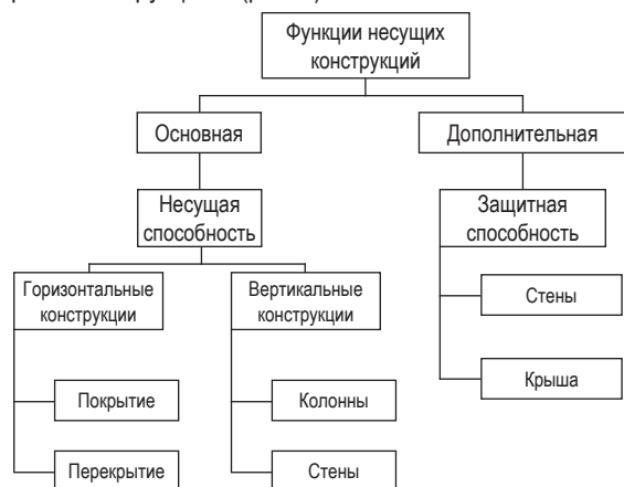
Рис. 2. Функции опорных конструкций
